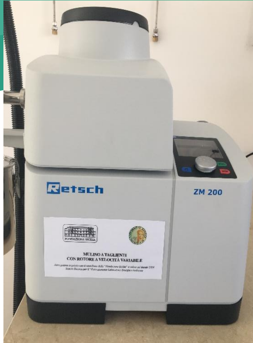
Figura. Mulino Retsch ZM 200 del Laboratorio di Energia e Ambiente (L.E.A.) dell'Università degli Studi di Enna "Kore" utilizzato per la macinazione.
