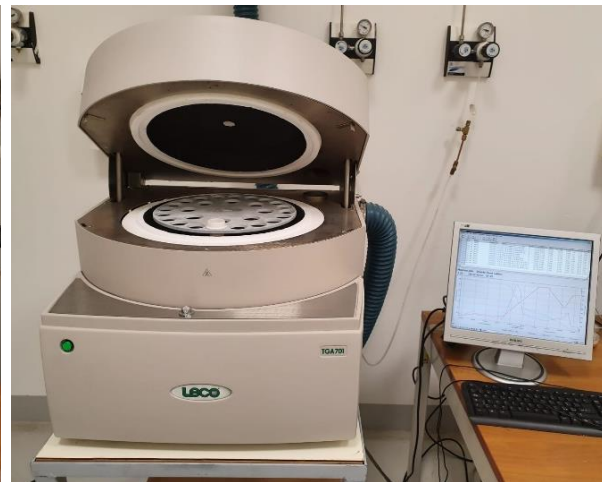
Figure. Bomba Calorimetrica LECO AC 500 e Analizzatore Termogravimetrico LECO TGA 701 del Laboratorio di Energia e Ambiente (L.E.A.) dell'Università degli Studi di Enna "Kore" utilizzati per la caratterizzazione composizionale ed energetica.
